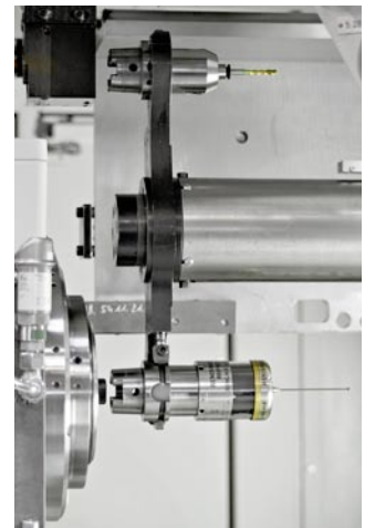
示例：配备 52 个换刀工具库，以及仅通过一次装夹即可完成复杂工件全面加工的换刀过程。
