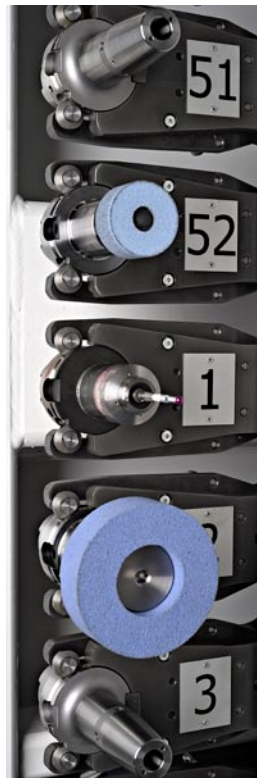
示例：配备 52 个换刀工具库，以及仅通过一次装夹即可完成复杂工件全面加工的换刀过程。
